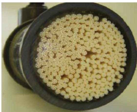
Schnitt durch die Filterkerze (Bild: PB International)
